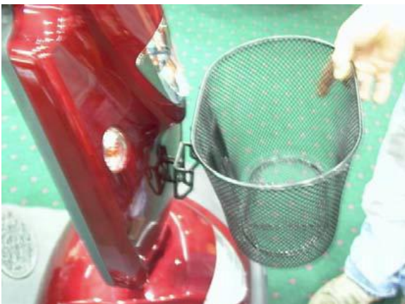
Első kosár telepítése
